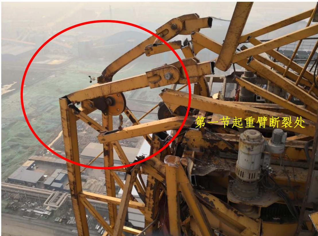
图 2-8 第一节起重臂断裂处
