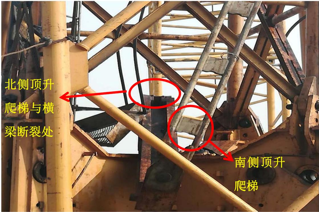
图 2-7 右侧顶升爬梯下端耳板与横梁断裂示意图
