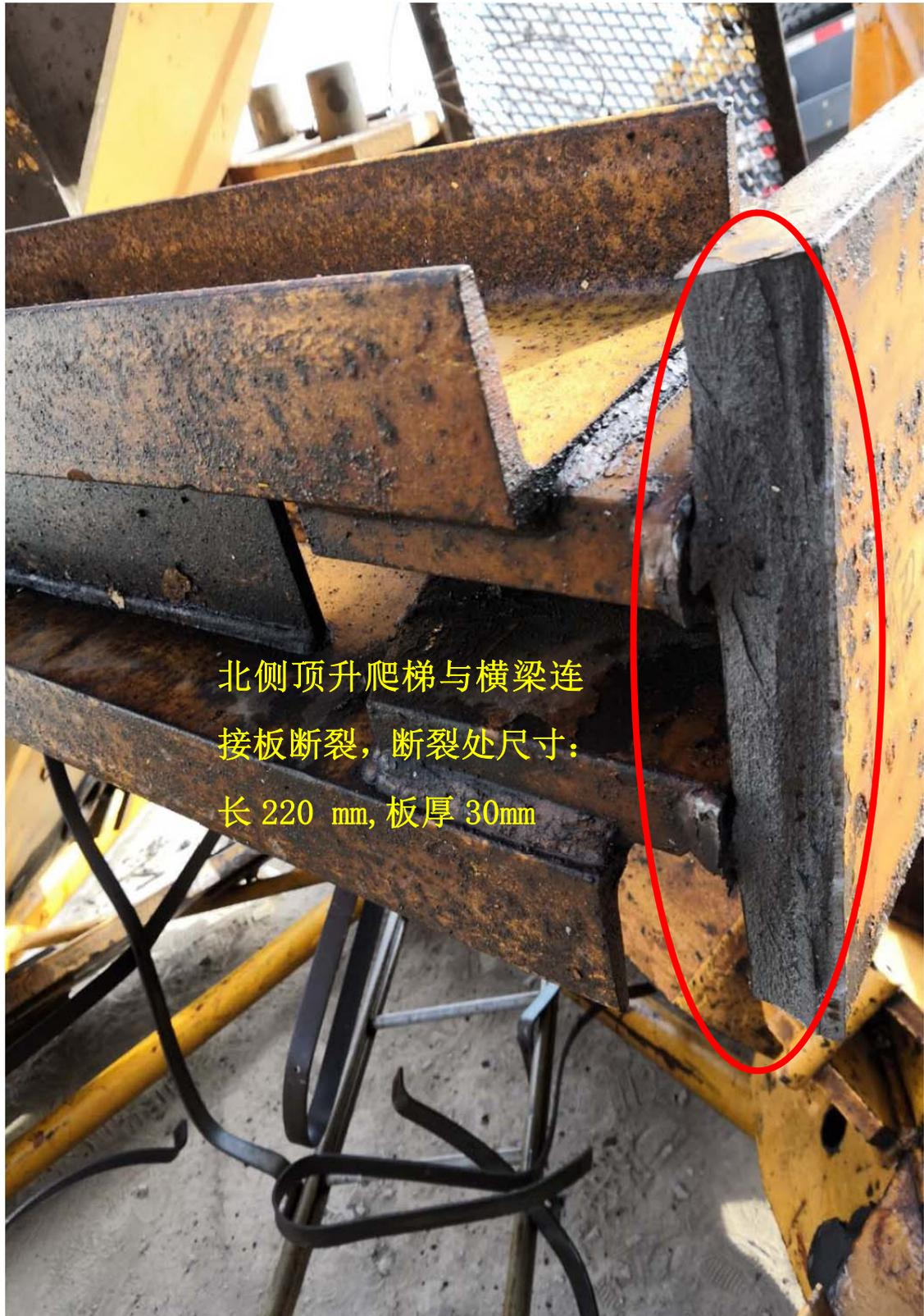
图 2-6 顶升爬梯与横梁连接板断裂处
