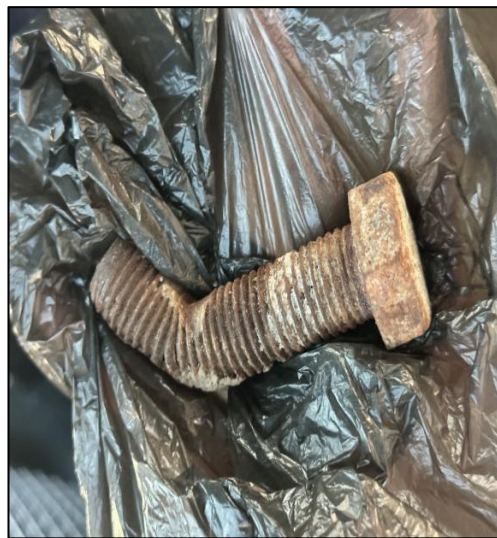
图 8 四角受力后弯曲的螺栓之一
